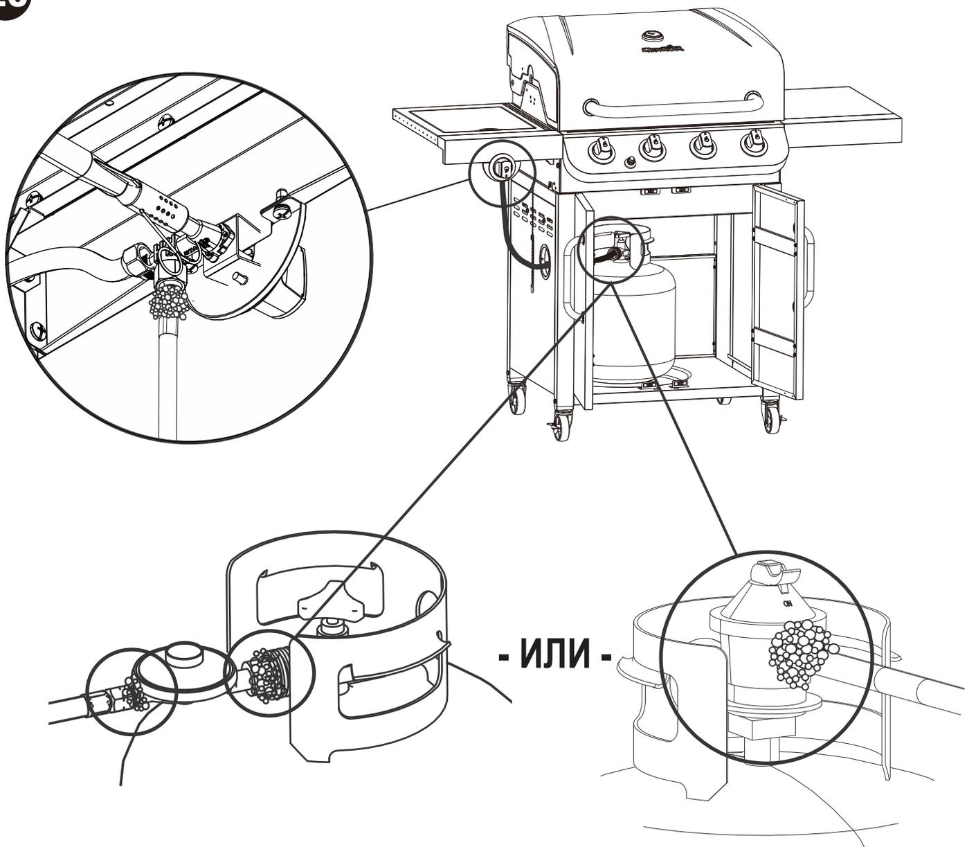
Проведите проверку утечек газа перед первым использованием. Проверку утечек газа необходимо проводить не реже одного раза в год, а также при каждой замене или подключении баллона.
